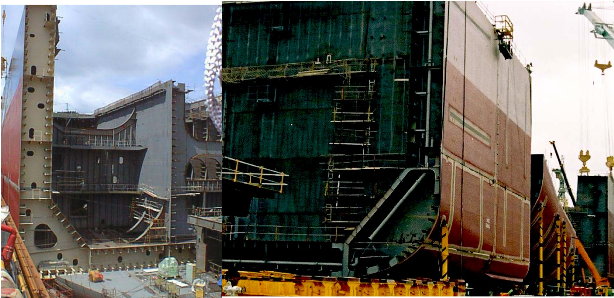
Рисунок 1. Конструкция двухкорпусного танкера
