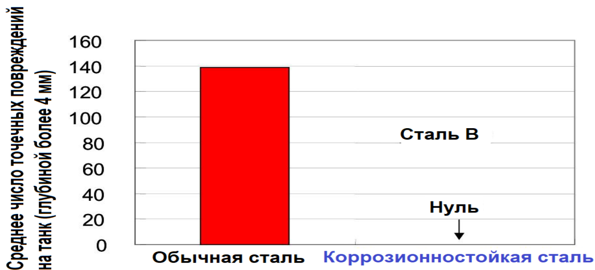
Рисунок 12. Частота точечной коррозии в грузовых танках
