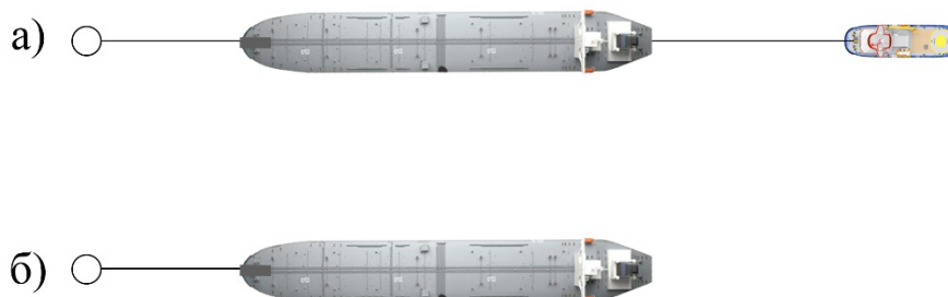
Рисунок 1 – Схемы швартовки к МОП: а) «МОП – танкер – буксир»; б) «МОП – танкер».
