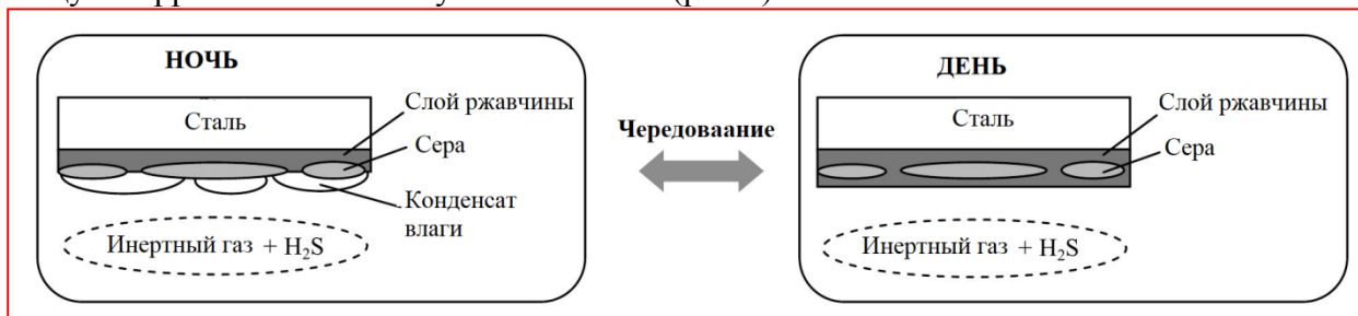
Рис.4. Механизм коррозии под верхней палубой
