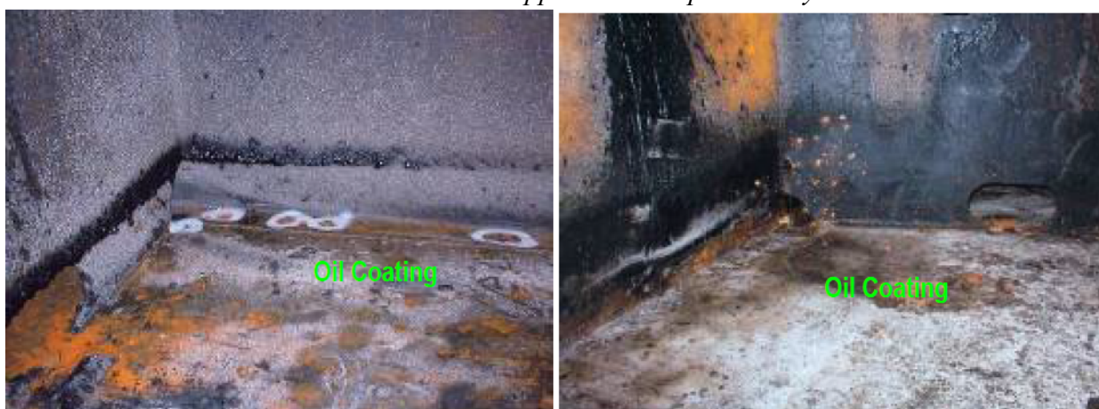
Рисунок 5. Примеры масляного слоя в грузовом танке танкера класса VLCC
